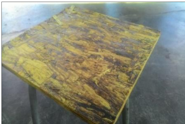
Rajah 3 : Sampel OSB yang gagal
